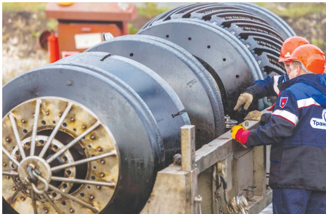
На фото: Сотрудники АО «Транснефть — Диаскан» при работе с ультразвуковым дефектоскопом.
